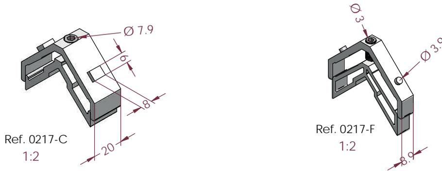
Realizar los siguientes mecanizados para la colocación de las escuadras:
